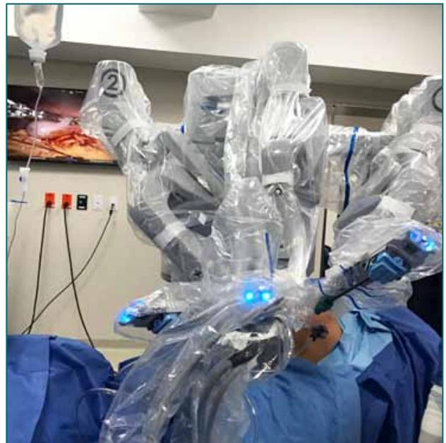
**Figura 4.** Robot Si. Docking robótico completo. Luz azul encendida. Verifica ensamble adecuado.
